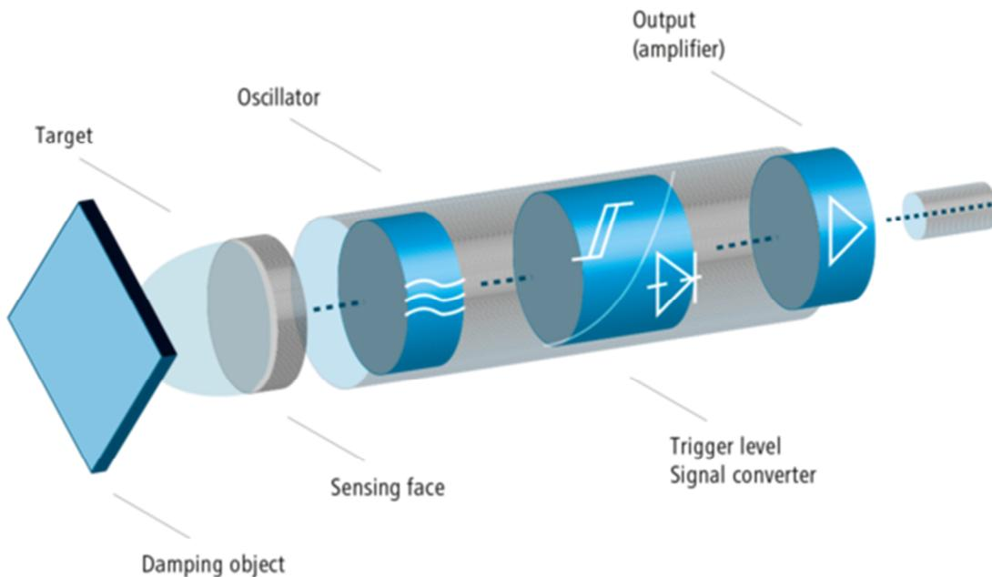
Les détecteurs de proximité inductifs de Baumer sont des détecteurs électroniques fonctionnant sans contact. Ils se composent de trois étages: l'oscillateur, l'étage de mise en forme et l'amplificateur de sortie.
