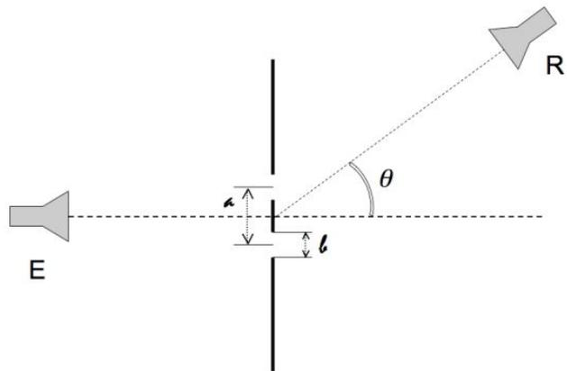
Pour simplifier le problème, on considère que la distance fente-détecteur est très grande devant la distance inter-fentes  $a$ . Cela revient à considérer les interférences à l'infini et estimer que l'on se trouve dans les conditions de Fraunhofer (ce qui n'est en réalité pas le cas). Il faut donc se placer à au moins 50cm des fentes, mais on ne peut se placer trop loin non plus, sous peine de ne plus avoir suffisamment de signal collecté.
