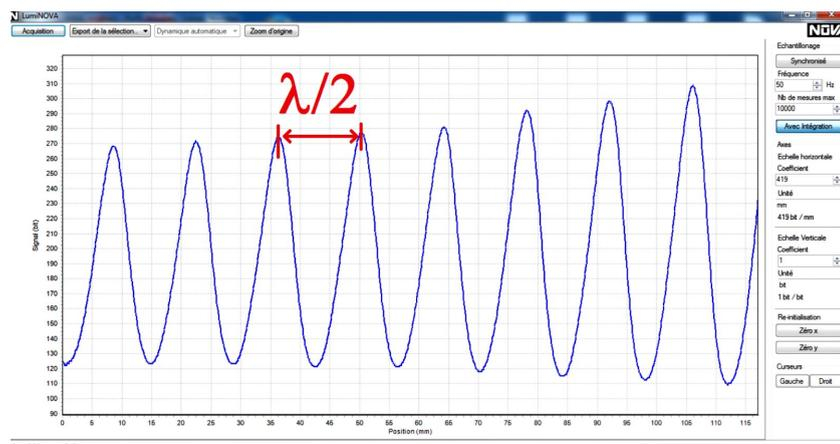
Relevé réalisé avec platine long trajet et logiciel d'acquisition Luminova.
