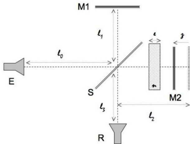
L'indice de réfraction peut être déterminé grâce à la relation :  $n = 1 + \frac{2z}{\lambda} + \frac{e}{\lambda} (n^2 - 1)$  est un entier négatif ou nul,  $e$  l'épaisseur de la plaque,  $z$  est le déplacement qui permet de retomber sur un maximum d'interférence (il est compté positivement lorsque l'on se déplace vers le miroir séparateur S).
