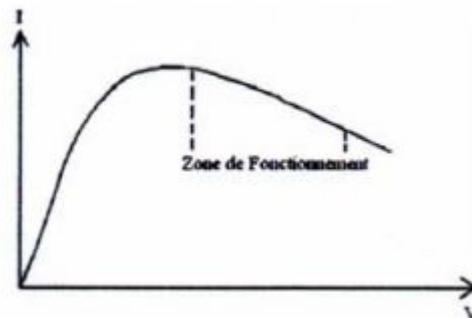
A partir d'une certaine tension, en général 4-5 volts, le graphe présente un coude et on note que l'intensité augmente quand la tension diminue. On dit qu'on a une résistance négative. Il importe donc dans un montage destiné à relever les caractéristiques de la diode Gunn de placer une résistance en série pour éviter de faire passer dans le composant une intensité trop forte risquant de le détruire.
