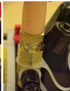
3- Emmancher le tuyau sur l'embout cranté ainsi fixé et enfoncer le fermement pour assurer l'étanchéité.
