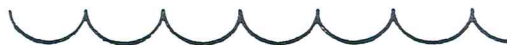
Fig. 11. Courbe de trajectoire du sommet du gyroscope lors de la libération sans provoquer de chocs.
