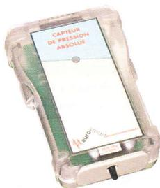
Ce capteur permet de mesurer des pressions absolues pour liquides et gaz.
