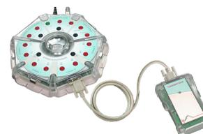
**NB :** le câble prolongateur réf. CESAR2 fourni en option, permet d'éloigner le transmetteur de la centrale tout en conservant les caractéristiques d'une connexion directe sur la centrale.
