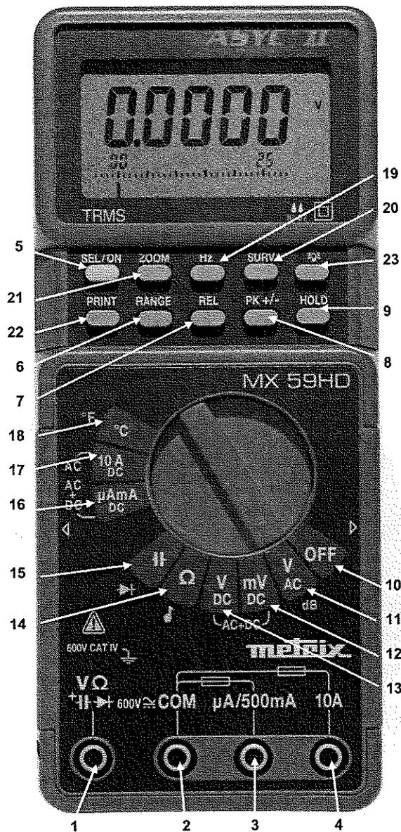
Multimètre digital portable
