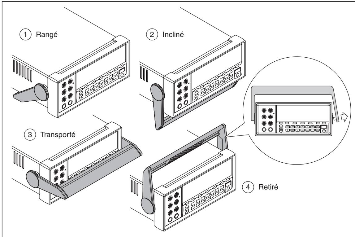
Figure 2-4. Retrait et réglage de la béquille
