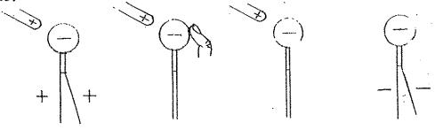
On peut également charger l'électroscope par contact avec un barreau métallique isolé.
