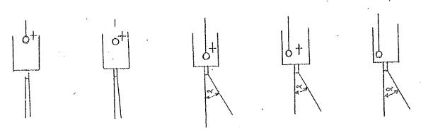
Quand on enfonce le corps dans l'électroscope, l'écart augmente, mais dès qu'il est à une certaine profondeur, l'écart de la feuille reste invariable et ne dépend pas de la position du corps pourvu qu'il reste bas.
