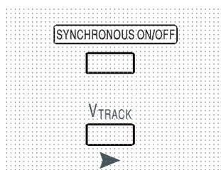
Une pression sur le bouton  $V_{TRACK}$  permet de sélectionner le mode d'appariement de tension. Les deux sorties restent isolées du point de vue électrique mais les commandes de tension de la sortie 1 (maître) règlent une tension identique sur la sortie 2 (esclave). Les commandes d'intensité du maître et de l'esclave restent indépendants.
