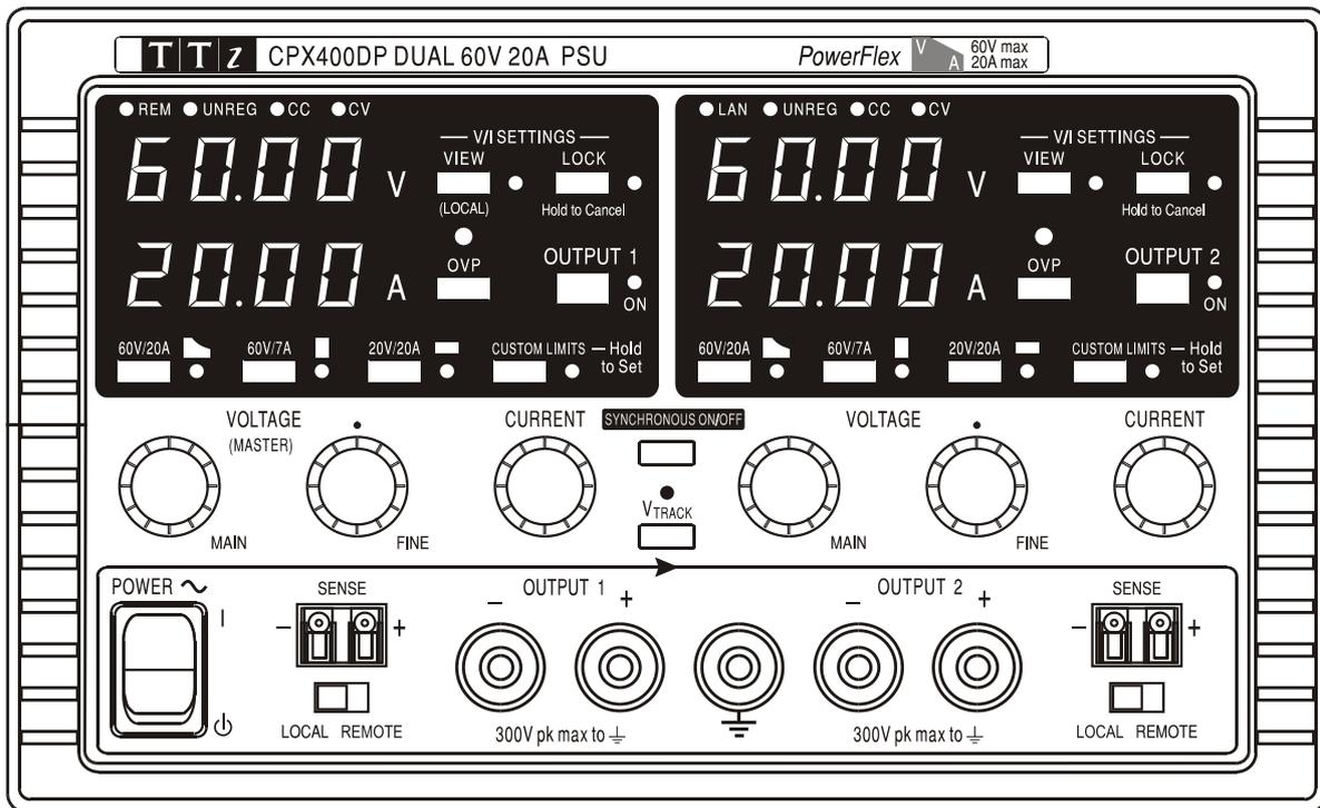
La charge devra être connectée aux bornes positive (rouge) et négative (noire) marquées OUTPUT (sortie). Les bornes de sortie OUTPUT sont calibrées à 30 A.
