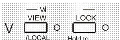
Les limites de tension et d'intensité réglées s'affichent toujours lorsque la sortie est désactivée mais peuvent également être lues lorsque la sortie est activée en appuyant sur la touche VIEW ; le voyant VIEW s'allume lorsqu'on appuie sur la touche VIEW.
