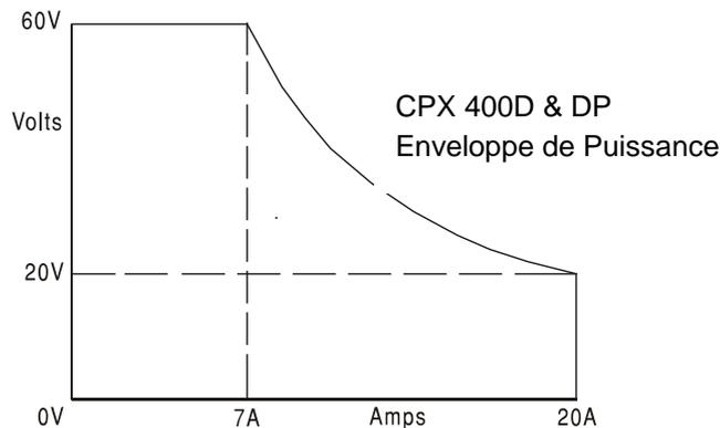
L'enveloppe de puissance est réglée pour donner 60 V/7 A, 42 V/10 A et 20 V/20 A lorsque toutes les conditions d'alimentation sont remplies (les deux sorties sont chargées) ; lorsque les tensions de sortie sont inférieures, l'intensité maximum de 20 A limite la puissance de sortie.
