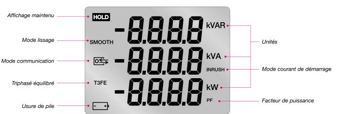
Avec l'afficheur LCD 73 x 54,3 mm, l'utilisateur sait d'un seul coup d'œil où il en est. Le voyant usure de pile l'avertit quand il ne reste plus qu'une heure d'autonomie.
