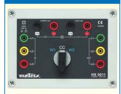
Le commutateur de wattmètres HX 0011 rend possible l'utilisation de la méthode des deux wattmètres à l'aide d'un seul wattmètre. Il permet la mesure en triphasé 3 fils non équilibré. Le commutateur de type inverseur bipolaire comporte des contacts auxiliaires assurant la continuité des circuits courant lors des commutations. Les mesures possibles sont, pour des
