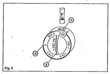
Pour changer le fusible primaire, on introduit une pièce de monnaie dans la fente (a) du sélecteur de tension et porte-fusible (b) et on tourne jusqu'à ce que le "0" coîncide avec la marque blanche (cf. fig. 2). Le fusible est alors projeté de l'ouverture (c) comme éjecté par un ressort. Le rattrapper à la main puis mettre le nouveau fusible dans l'ouverture (c); l'enfoncer à l'aide d'un objet pointu (stylo à bille ou tournevis) tout en tournant la pièce dans la fente (e).
