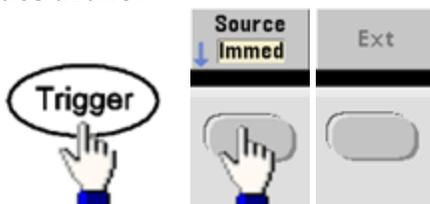
Pour indiquer si l'instrument se déclenche sur un front montant ou descendant, appuyez sur **Trigger Setup** et sélectionnez le sens du front en appuyant sur **Slope**.
