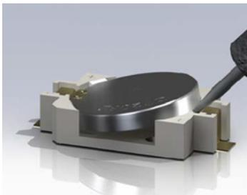
5. Retirez la batterie et mettez-la au rebut ou recyclez-la conformément à l'ensemble des réglementations en vigueur.
