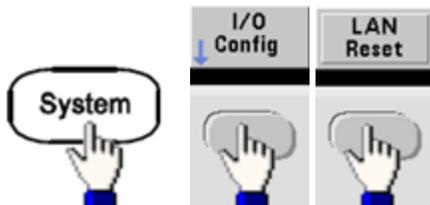
Le message « Performing LAN Reset » (Réinitialisation en cours du réseau local) s'affiche lorsque le réseau local est réinitialisé.
