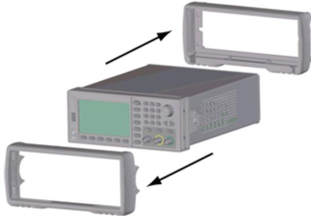
4. Desserrez les deux vis imperdables (entourées en rouge ci-dessous) du cadre arrière et déposez le cadre.
