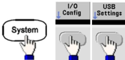
La série 33500 n'inclut aucun paramètre USB pouvant être configuré par l'utilisateur. Vous ne pouvez extraire la chaîne d'identification USB (configurée par le fabricant) qu'à l'aide de la touche de fonction **Show USB Id**.
