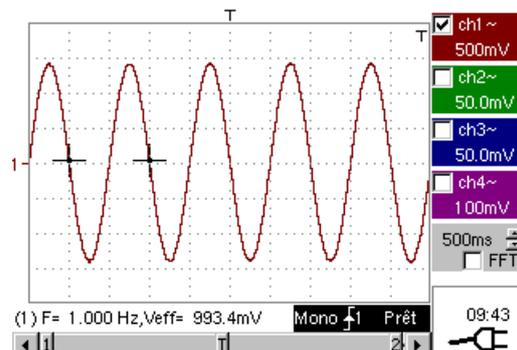
Le signal est analysé en permanence (mode « RUN »). Cette fonction de défilement horizontal de la trace permet de suivre l'évolution de la forme du signal.
