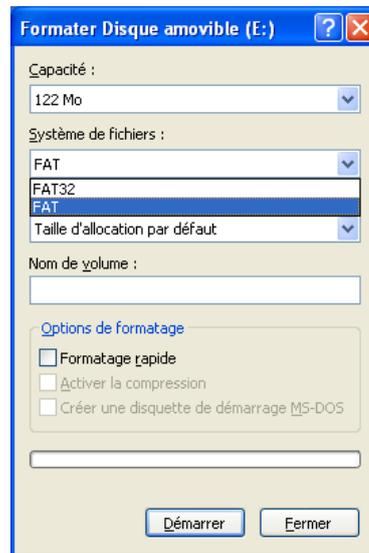
4. Dans le pavé « Système de Fichiers », sélectionnez l'option FAT et non FAT32 qui n'est pas compatible avec l'oscilloscope. Cliquez sur : « Démarrer ».
