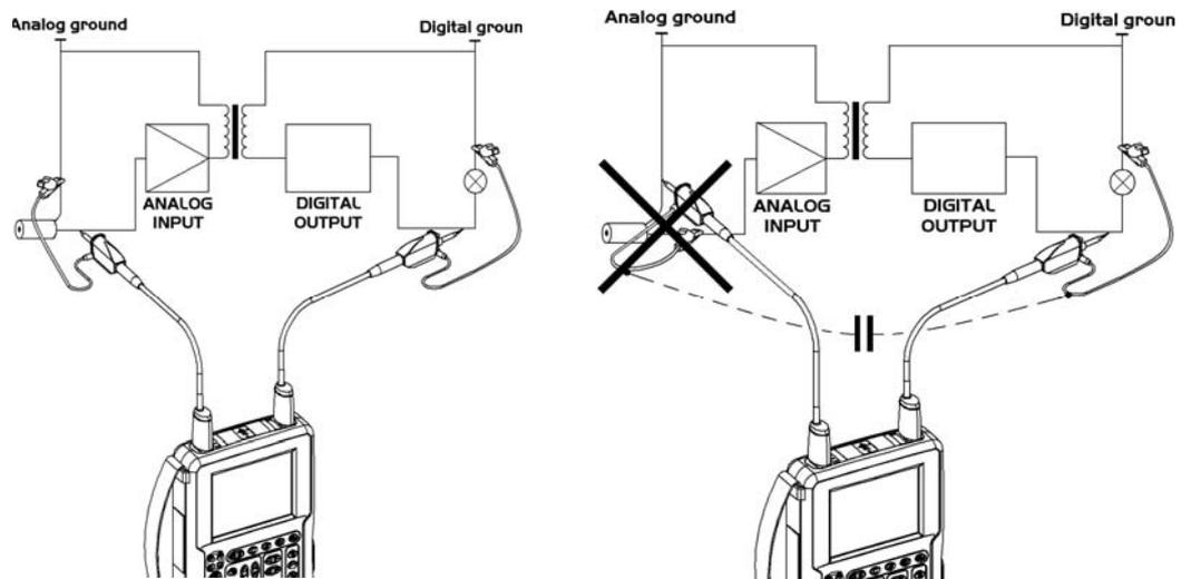
Le bruit de la masse digitale est transmis à l'entrée analogique par la capacité parasite.
