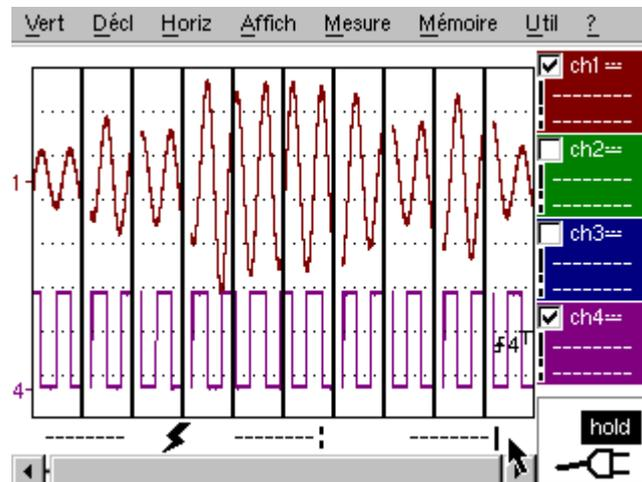
La mémoire est segmentée pour permettre l'acquisition de plusieurs défauts (10 défauts dans la configuration standard, 100 si l'option EXTENDED ACQUISITION MEMORY est installée).
