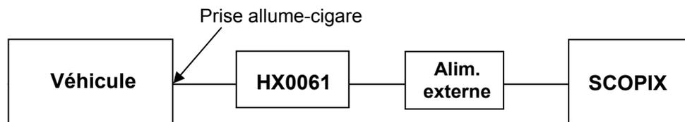
Le module HX0061 est livré équipé d'une prise allume-cigare 12 VDC/24 VDC couramment utilisée en automobile.
