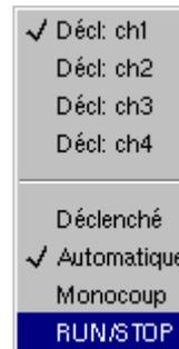
RUN/STOP permet le lancement et l'arrêt de l'acquisition depuis ce menu. L'état de l'acquisition est indiqué dans la zone d'état de l'écran.
