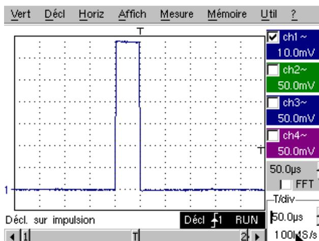
☞ L'oscilloscope déclenche lorsque la largeur de l'impulsion du signal est supérieure à la largeur d'impulsion spécifiée (25.0  $\mu$ s + la tolérance).
