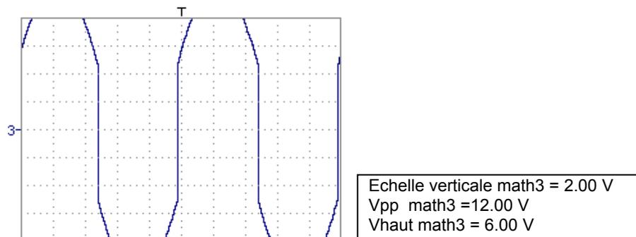
Nous constatons un dépassement haut et bas, une division par 2 est nécessaire pour optimiser la représentation du résultat.
