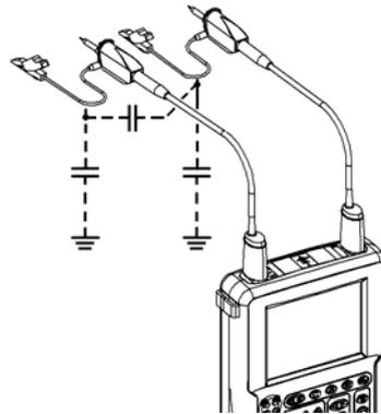
Il est impératif, compte tenu des capacités parasites, de connecter correctement les conducteurs de référence de chaque sonde. Ces conducteurs doivent, de préférence, être reliés aux points froids, pour éviter la transmission des bruits par la capacité parasite entre mode.
