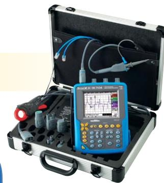
Les modes oscilloscope, multimètre, analyseur d'harmoniques, et enregistreur sont directement accessibles sur la face avant de l'instrument.
