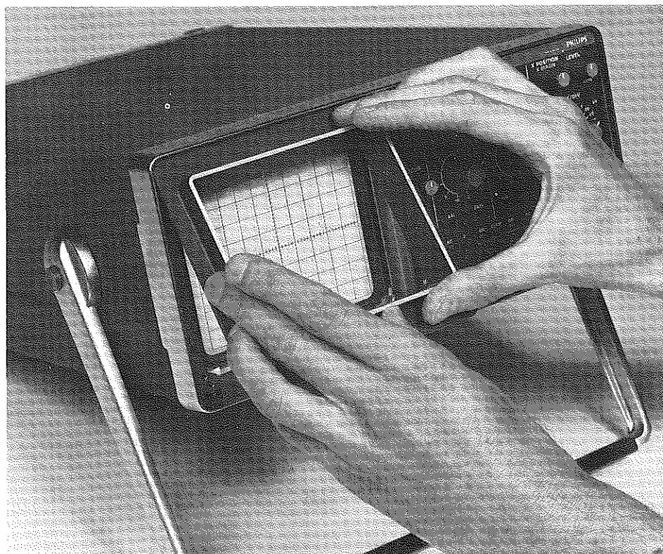
Fig. 2.6. Dépose de la visière et de plaque de contraste
