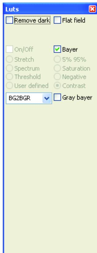
Le décodage Bayer est une opération qui transforme une image en niveaux de gris en image couleur. Cette opération est réalisée sur des capteurs possédant une matrice de Bayer pour générer l'information couleur (filtres colorés rouge/vert/bleu devant les pixels).
