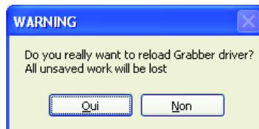
Cette fonctionnalité recharge le conteneur d'image en cours, ce qui provoque un rechargeement du driver CVB. Toutes les données en cours seront perdues. La modification de certains paramètres des cameras réalisée par le logiciel Caméra Tool nécessite l'utilisation de cette fonction. **Attention : son utilisation peut malgré tout provoquer des instabilités.**
