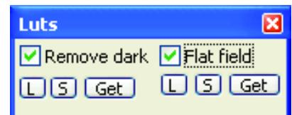
Des boutons s'affichent en dessous, *L* pour charger une image de fond uniforme, *S* pour sauvegarder l'image courante du container d'image comme image de fond uniforme, *Get* pour acquérir l'image en cours et l'utiliser comme image de fond uniforme.
