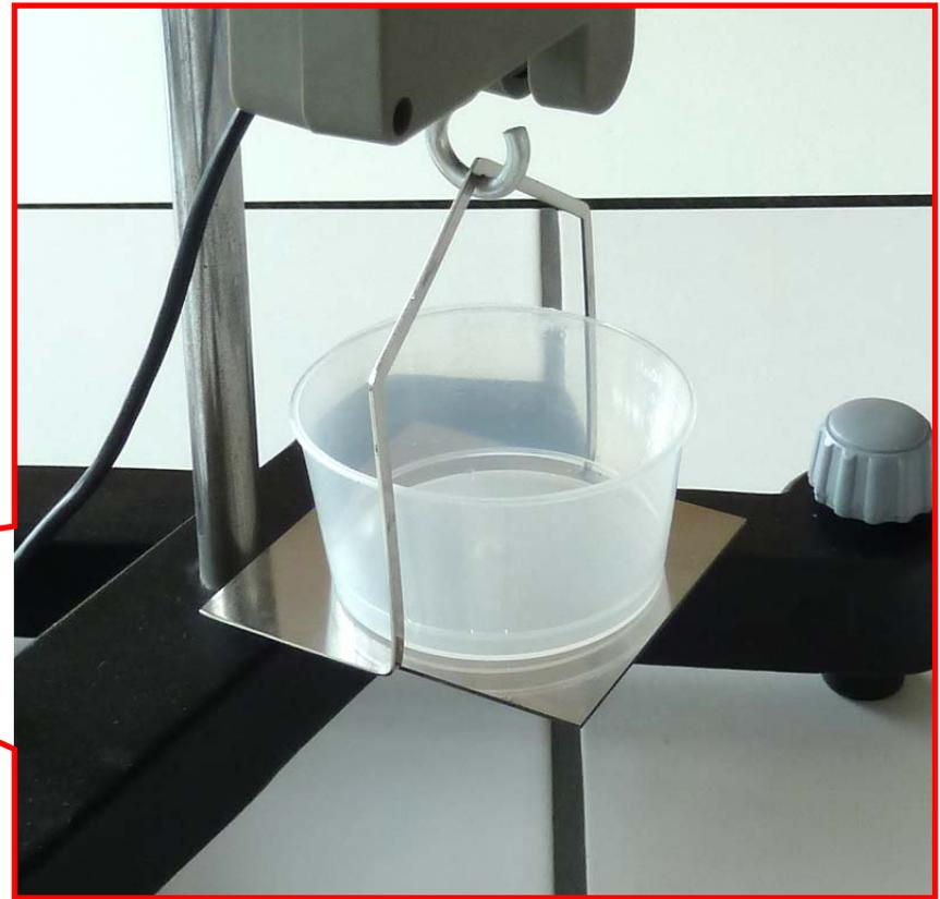
Suspendre l'autre capteur Force au support prévu dans le kit "Principe de la poussée d'Archimède" par le crochet support
