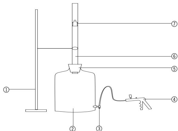
En liaison avec le flacon de Mariotte U14327, le tube de précision permet de déterminer l'exposant adiabatique  $c_p/c_v$  d'après Rüchardt.
