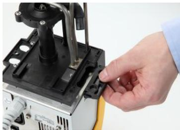
Le kit de connexion de pompe peut être fixé sur le côté de la tête de contrôle. Lorsque la tête de contrôle est montée en sens inverse et que le câble secteur se trouve côté utilisateur, celui-ci est à droite (voir illustration).
