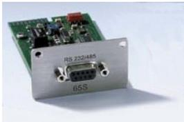
Module d'interface RS232/485 (n° réf. LRZ 913) avec douille SUB-D 9 pôles. Séparé galvaniquement par des coupleurs optoélectroniques. Avec un jeu de commande LAUDA compatible avec les séries Ecoline, Proline et Integral. L'interface RS232 peut être raccordée directement sur le PC via un câble à contact 1:1 (n° réf. EKS 037, câble 2m et EKS 057, câble 5m).
