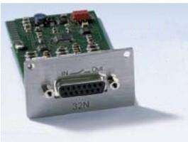
Module de contact (n° réf. LRZ 915) sur douille SUB-D 15 pôles. Fonctionnalité comme LRZ 914 mais contact relais avec 3 sorties (inverseur, max. 30 V/0,2 A) et 3 entrées binaires pour une commande via des contacts externes exempts de potentiel :
