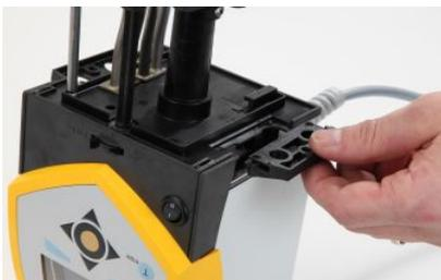
La fixation du serpentin de refroidissement n'est réalisable que d'un seul côté de la tête de contrôle. Le point de raccordement se trouve du côté de l'interrupteur secteur (voir illustration).
