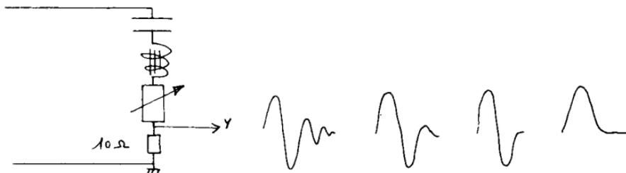
quand on veut mettre en évidence les différents régimes, oscillants ou non, on change cette résistance. Pour ne pas avoir à toucher constamment l'oscilloscope, il est commode de mettre une petite résistance fixe en série avec la résistance variable. Sans être constante, l'amplitude du signal change moins et on n'a pas à changer le gain vertical.
