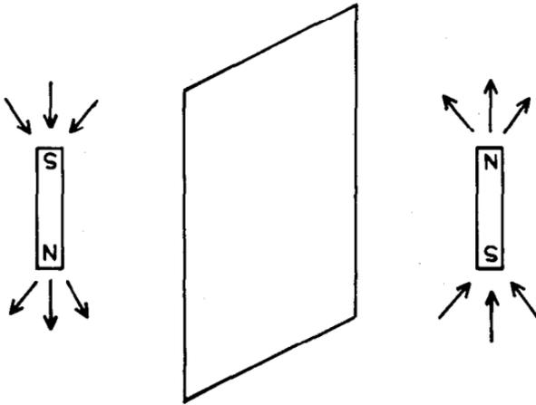
Fig. 8. — Image d'un aimant dans un miroir.
