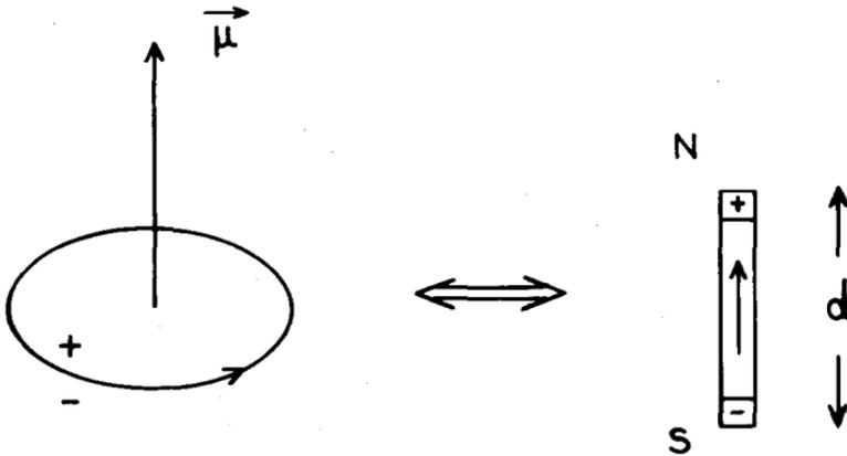
Fig. 5. — Masses magnétiques  $+n$  et  $-n$  associées à une spire de courant de moment magnétique  $\vec{\mu}$  ( $nd = \mu$ ).
