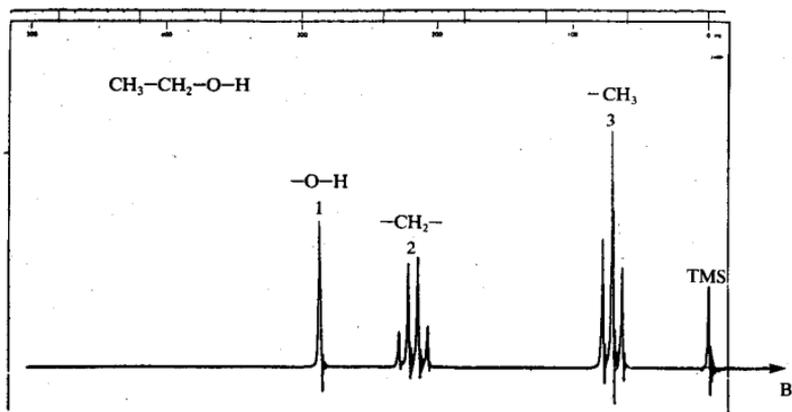
Figure 6. — Spectre RMN de l'éthanol
