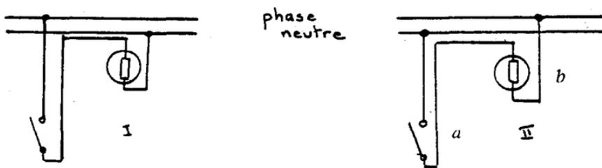
Ces 2 installations sont identiques sur le plan du fonctionnement, mais dans le montage II les fils *a* et *b* sont dangereux, même l'interrupteur ouvert, et il y a risque d'électrocution lors du remplacement de la lampe. Alors que dans le montage I, le changement de la lampe ne présente pas de risque.
