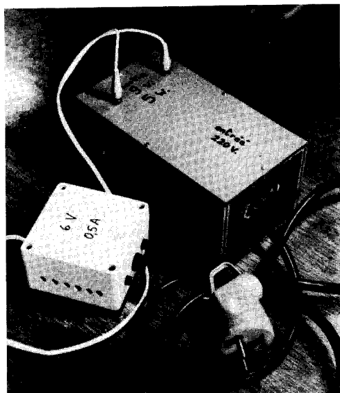
Une alimentation branchée sur le transformateur destiné à l'ensemble des 10 alimentations (voir 5 et 3 sur le plan de la classe).
