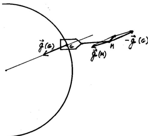
Fig. 5. — Découpe de la stabilisation d'attitude par gradient de gravité.
