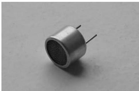
**Figure 8** : Photographie d'un émetteur ultrasonore.
