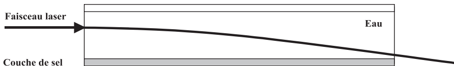
Figure 3 : Schéma montrant le trajet du faisceau laser dans une section verticale de la cuve.
