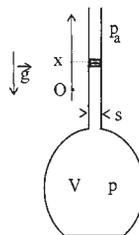
On suppose qu'au cours de l'expérience la pression  $p$  et la température  $t$  sont uniformes dans le réservoir et la partie inférieure du tube et que les échanges de chaleur n'ont pas le temps de
