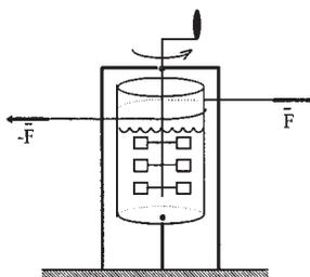
L'opérateur exerce alors un couple antagoniste de moment  $M$ . Les forces  $\vec{F}$  et  $-\vec{F}$  agissent sur le calorimètre par l'intermédiaire de cordelettes enroulées autour de ce dernier.
