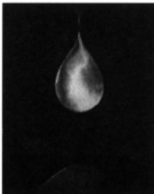
Fig. 2.4.15: Effet Beg-Rohu: instabilité du ménisque qui résulte en formation d'une presqu'île<sup>[28]</sup>.
