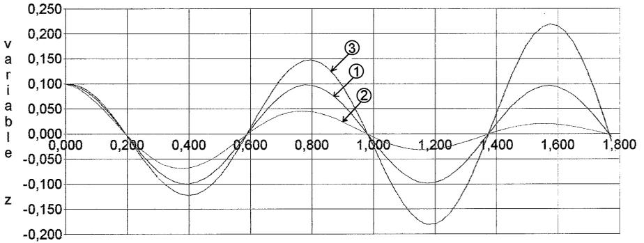
**Figure 1 :** Solution de l'équation différentielle  $\ddot{z} + A \dot{z} + \omega_0^2 z = 0$ .
