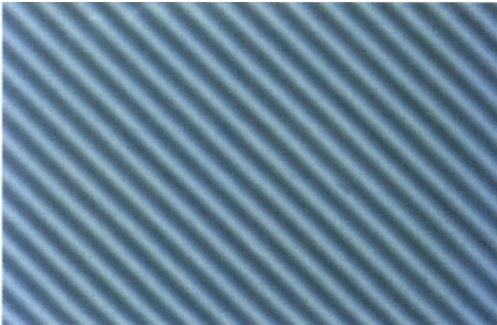
**Photo 6** : Modification de l'image par filtrage optique. L'objet est une trame régulière formant un réseau croisé (*voir figure 40*) ; le filtrage est obtenu à l'aide d'une fente (*voir le montage de la figure 44*). Quand la fente est perpendiculaire aux diagonales du réseau, on obtient une image fictive formée d'un ensemble de traits perpendiculaires à la fente. En fait, la répartition de la lumière est pratiquement sinusoïdale à cause de la disparition des hautes fréquences.
