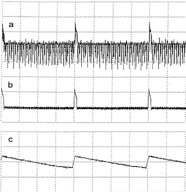
**Figure 6 :** Balayage trame détecté avec quatre spires.
