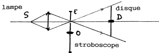
Figure 3 : Disque obturateur tournant devant une lampe pour éclairer D.
