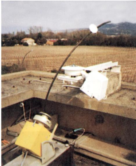
**Photo 4 :** Pyrgeomètre - Mesure du **rayonnement infrarouge de grande longueur d'onde réémis par l'atmosphère** vers la Terre. Un filtre de silicium empêche les radiations de courte longueur d'onde d'atteindre la thermopile. Le capteur est maintenu à l'ombre toute la journée afin d'éviter l'échauffement du filtre lui-même.
