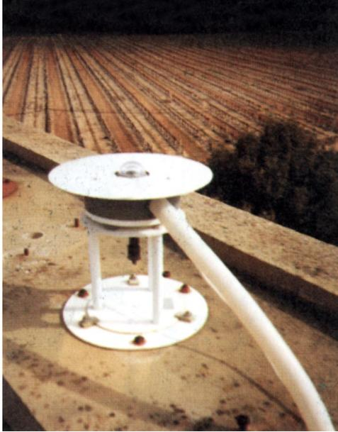
**Photo 1 : Pyranomètre** - Mesure du **rayonnement solaire global**. Deux hémisphères de verre protègent la thermopile et filtrent les radiations incidentes. Une ventilation entre les deux hémisphères évite la formation de buée ou de givre.
