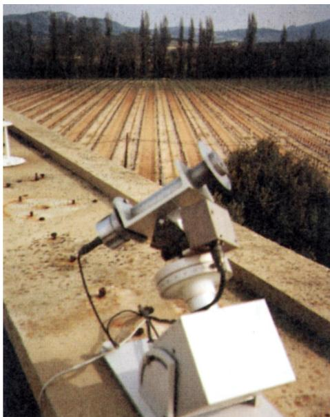
**Photo 2 : Pyrhéliomètre** - Mesure du **rayonnement solaire direct**. Le capteur vise constamment la direction du Soleil grâce à une monture équatoriale pilotée par servomoteur.
