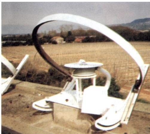
**Photo 3 : Pyranomètre** - Mesure du **rayonnement solaire diffus**. Une bande pare-soleil maintient les hémisphères du pyranomètre à l'ombre du rayonnement solaire direct.
