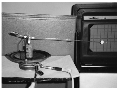
Figure 1 : l'amplificateur utilisé est celui qui est intégré dans le générateur de fonction BF - TBF de chez Matelco. Celui-ci conserve quelques qualités à une fréquence aussi basse dans la mesure où il est peu sollicité.
