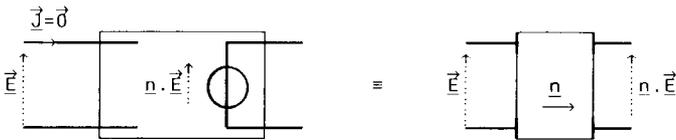
En utilisant alors la représentation de Thévenin et le milieu étant modélisé par une impéditivité  $\mathcal{Z}$ , le modèle obtenu en III) se ramène alors au schéma suivant :
