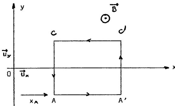
Le moteur est un cadre carré  $AA'C'C$  (cf. figure) de côté  $a$ , se déplaçant dans le plan  $xOy$ , parallèlement à l'axe  $Ox$ . On repère la position du cadre à un instant donné par l'abscisse  $x_A$  du côté  $AC$ . Dans tous les cas étudiés le cadre est initialement au repos avec  $x_A = 0$  m.
