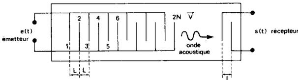
Figure 4. - Schéma du filtre à onde acoustique
