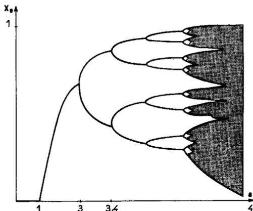
**Figure 21** : le chaos. Lorsque a continue à augmenter, les bandes apparues dans la figure 17 se recouvrent. Il n'est donc plus possible de «classer» dans des bandes données les valeurs «aléatoires» prises chaque année par la population d'insectes ; l'évolution apparaît maintenant comme complètement aléatoire (voir figure 22).
