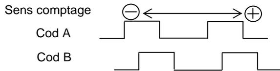
Fréquence maximum : 50KHz (200 000 transitions par seconde)
