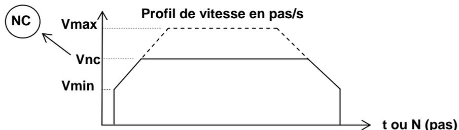
La nouvelle consigne de vitesse  $V_{nc}$  permet de tronquer provisoirement la loi d'accélération initiale. Lors des mouvements point à point (NP, NXW, NH)
