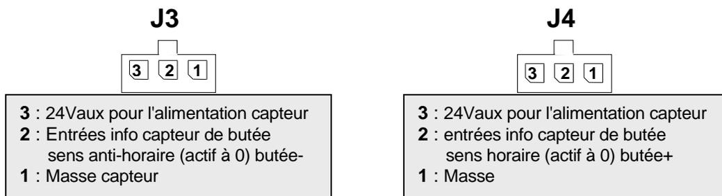
Ces 2 butées sont connectées respectivement en entrées logiques 8 (butée-) et 7 (butée+) via les switches Cx2 et Cx1.
