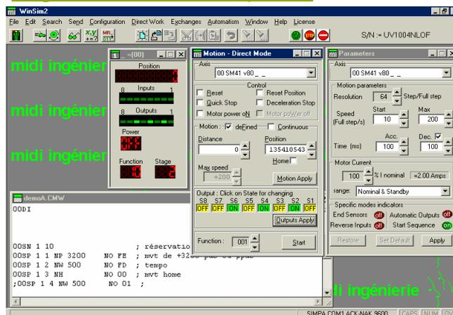
Le logiciel WINSIM 2, est une interface opérateur permettant le dialogue avec un ou plusieurs modules des familles MICROSIMPA, SIMPA Micropas et MAC depuis un ordinateur de type PC fonctionnant sous Windows 95, 98, NT, Millenium ou XP.
