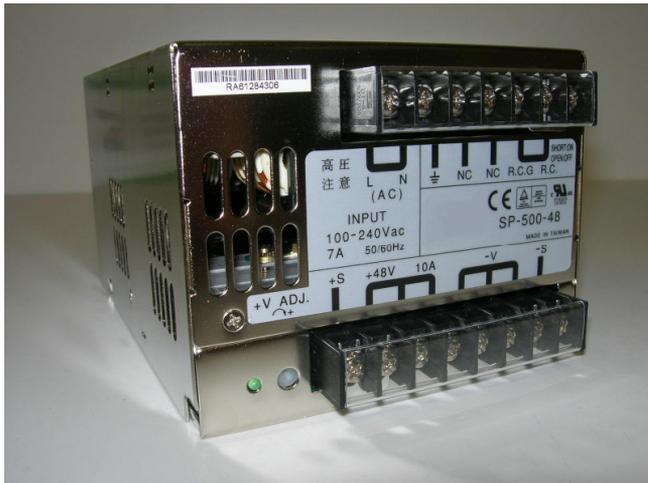
La SP 500-48 est un module d'alimentation à découpage 48 VDC, 500 W avec contrôleur du facteur de puissance intégré.
