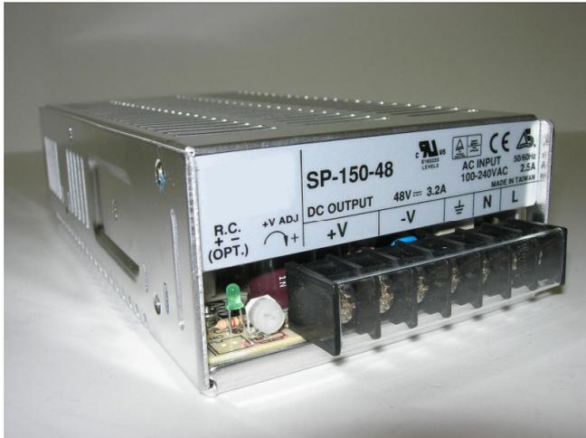
La SP 150-48 est un module d'alimentation à découpage 48 VDC, 150 W avec contrôleur du facteur de puissance intégré.
