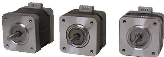
Les moteurs de la famille 17 PM sont des moteurs pas à pas hybrides biphasés 200 pas par tour de taille 17, compatibles micropas, avec rotor monté sur roulements à billes de précision.
