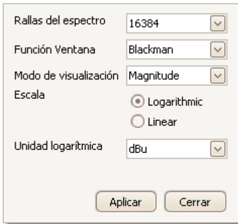
**Colectores** El número de colectores de frecuencia en que se divide el espectro. Este de espectrocontrol configura el número máximo de colectores de frecuencia que el software puede o no proporcionar, en función de otros ajustes. La limitación principal es que el número de colectores no puede superar en exceso la mitad del número de muestras de la forma de onda de origen.
