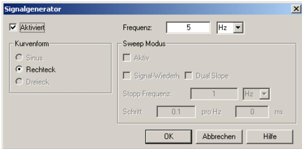
Mit Hilfe dieses Dialogfelds können Sie Frequenz, Wellenform und Zeitablenkung des Signalgenerators einrichten. Die verfügbaren Einstellungen hängen vom jeweiligen Oszilloskop ab.
