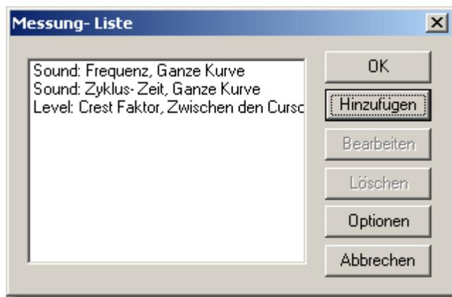
Im Dialogfeld **Messung-Liste** befindet sich eine Auflistung von Messungen, die im Oszilloskop-Fenster angezeigt werden.
