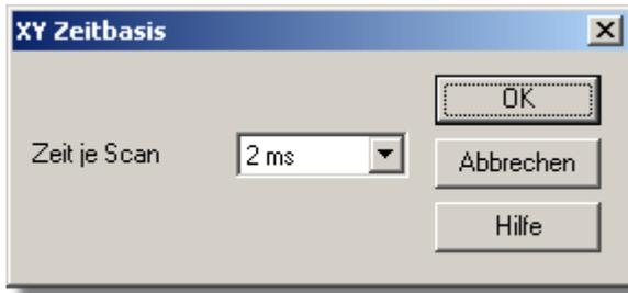
Mit Hilfe dieses Dialogfelds wird die Zeitbasis (x-Achse) für das aktive Oszilloskop-Fenster eingerichtet. Diese Funktion steht auch in der Oszilloskop-Werkzeugleiste zur Verfügung.
