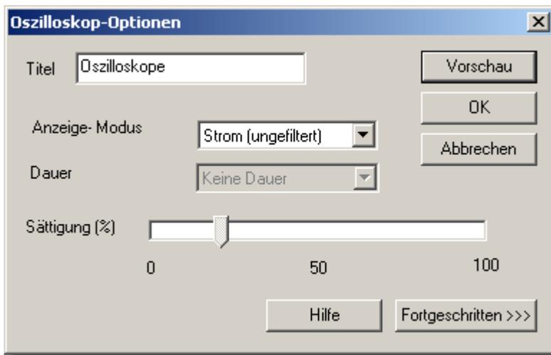
Mit Hilfe dieses Dialogfelds lassen sich verschiedene Optionen für das aktive Oszilloskop-Fenster einrichten. Arbeitet das Oszilloskop, während dieses Dialogfeld aktiviert ist, können Sie die Einstellungen über die Schaltfläche **Vorschau** direkt auf die angezeigte Kurve übertragen. Sie können diese Einstellungen speichern, indem Sie auf **OK** klicken oder den ursprünglichen Zustand wieder herstellen, indem Sie auf **Abbrechen** klicken.
