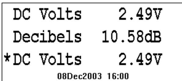
Hinweis: Wenn Sie das Oszilloskop im Standard-Modus oder zur Diagrammaufzeichnung verwenden und die Zeitbasis niedriger als 200 ms/div liegt, werden die Multimeterdaten nicht aktualisiert.
