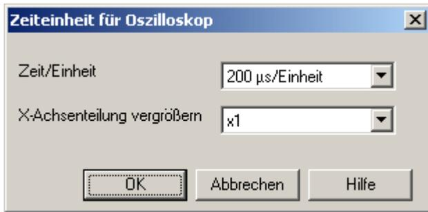
Mit Hilfe dieses Dialogfelds wird die Zeitbasis (x-Achse) für das aktive Oszilloskop-Fenster eingerichtet. Diese Funktion steht auch in der Oszilloskop-Werkzeugleiste zur Verfügung.
