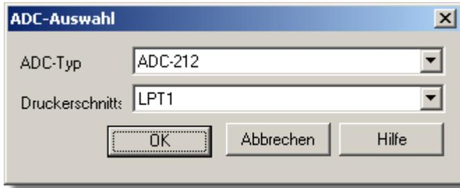
Mit Hilfe dieses Dialogfelds wählen Sie Ihr Oszilloskopmodell und den Eingang, an den es angeschlossen ist. Bei Verwendung eines Oszilloskops aus der PicoScope Serie 2000 oder 3000 muss der Anschluss nicht angegeben werden.
