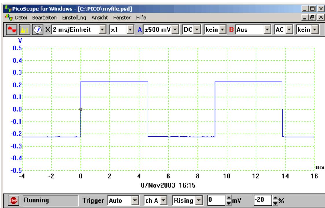
Wird das Triggersignal nur einmal gesendet, kann die Möglichkeit genutzt werden, die Datenerfassung direkt nach dem Signal zu beenden. Dazu aktivieren Sie im [Trigger-Dialogfeld](#) die Option **Stopp nach Triggern** oder setzen in der [Sampler/Trigger-Werkzeugleiste](#) den Triggermodus auf **Einzeln**.
