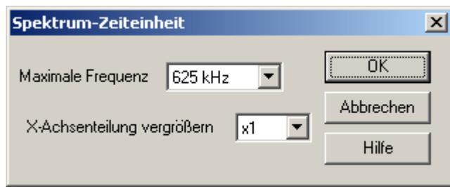
Mit Hilfe dieses Dialogfelds wird die maximale Frequenz vorgegeben. Diese Funktion steht auch in der Spektrumanalysator-Werkzeugleiste zur Verfügung.
