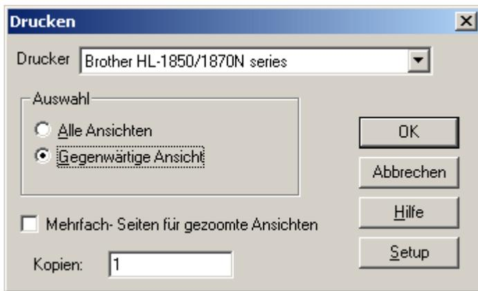
Mit Hilfe dieses Dialogfelds können Sie das aktive Fenster oder alle Fenster drucken. Möchten Sie das aktive Fenster drucken, wählen Sie die Optionsschaltfläche neben **Gegenwärtige Ansicht** und klicken auf **OK**. Möchten Sie alle Fenster drucken, wählen Sie die Optionsschaltfläche neben **Alle Ansichten** und klicken auf **OK**.
