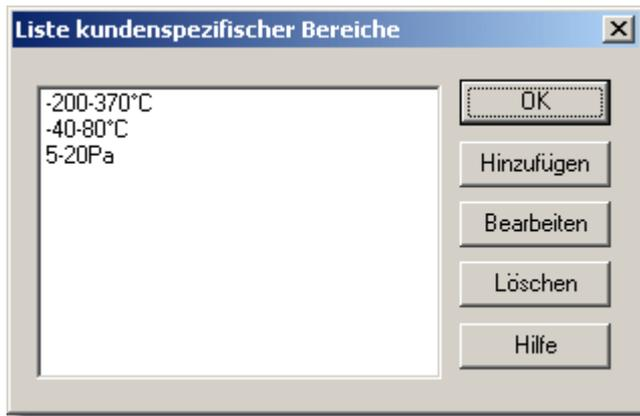
Mit diesem Dialogfeld verwalten Sie eine benutzerdefinierte Bereichsliste. Der benutzerdefinierte Bereich befindet sich im Dialogfeld der [ADC-Kanäle](#) unter den Spannungsbereichen.
