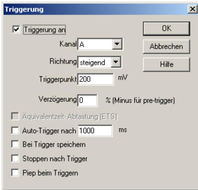
Mit Hilfe der Trigger-Funktion können Sie einen bestimmten Zeitpunkt definieren, zu dem PicoScope mit der Datenerfassung für die Anzeige beginnt. Hierbei handelt es sich normalerweise um einen festgelegten Zeitpunkt vor oder nach einem Triggersignal. Die aktuellen Triggereinstellungen gelten für alle Fenster (das heißt, dass nicht für jedes Fenster eine eigene Triggereinstellung vorgegeben werden kann).
