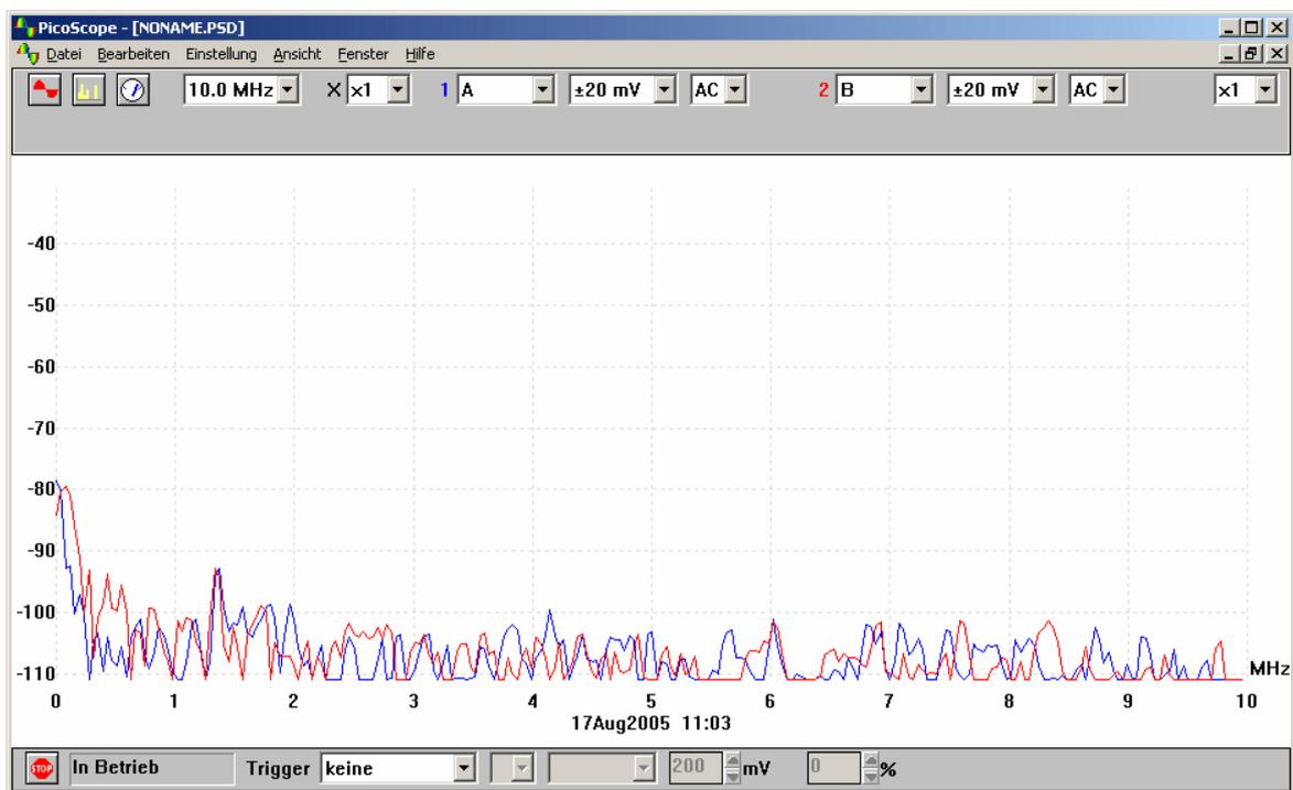
Der Spektrumanalysator arbeitet mit einer schnellen Fouriertransformation (FFT), um die in einem festen Zeitintervall gemessenen Daten in eine Verteilung umzuwandeln und stellt diese als Energiebetrag für jede Frequenz innerhalb eines Frequenzbandes bis zu einer Maximalfrequenz dar. Die Maximalfrequenz entspricht hierbei der halben Samplefrequenz.
