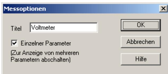
Mit Hilfe dieses Dialogfelds werden die Optionen für das aktive Multimeter-Fenster eingerichtet.
