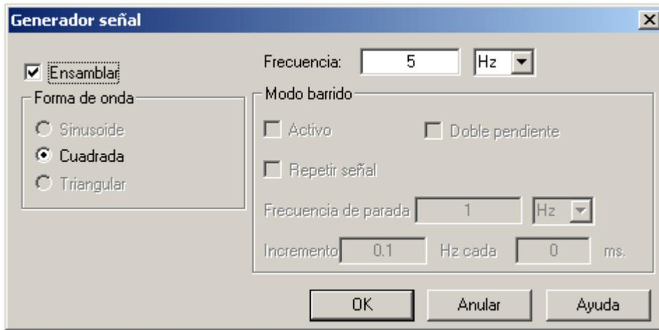
Este cuadro de diálogo le permite ajustar la frecuencia, la forma de onda y barrer la configuración del generador de señales. Las configuraciones disponibles varían dependiendo del osciloscopio que se use.
