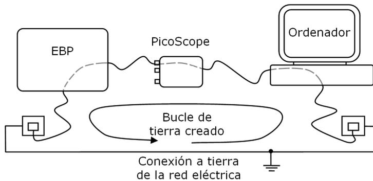
La mayoría de fuentes de alimentación eléctrica (cargadores) de equipos portátiles son flotantes y no tienen referencia de tierra. Si, sin embargo, conectar una fuente de alimentación para ordenador portátil conectada a tierra causa problemas de ruido / desviación de la tensión, puede utilizar el osciloscopio con el ordenador portátil alimentándose de su batería o que el osciloscopio reciba la alimentación eléctrica con el adaptador de corriente incluido.
