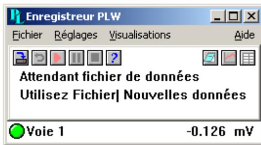
12. Brancher une tension adéquate (par exemple une pile de 1,5V) sur la voie. Les connexions à broches sont indiquées sur l'enregistreur et également listées dans le chapitre [Connecteur analogique](#).
